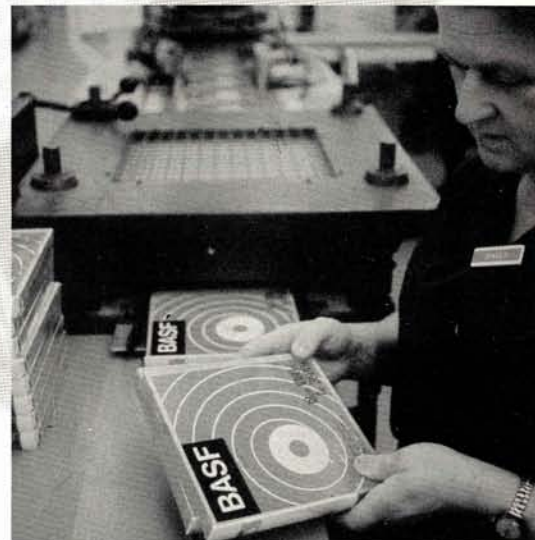
Procedimento analogo per il nastro in bobina. Il tipo al cromo della Basf è utilizzato come 'nastro di riferimento'.
