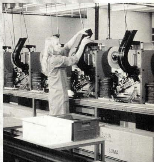
Entriamo nella fase finale, dove il prodotto viene ultimato. Qui si assemblano i gusci delle cassette.
